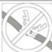
Sprawdzić urządzenie pod względem uszkodzonych przewodów
